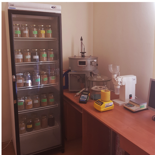
Stanowisko do wzorcowania wilgotnościomierzy nasion oleistych i ziaren zbóż
