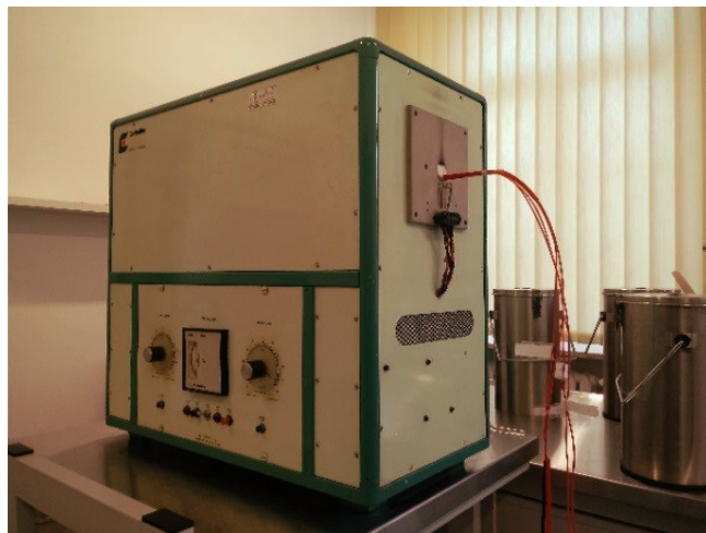
Stanowisko pomiarowe do wzorcowania termoelementów metodą porównawczą
