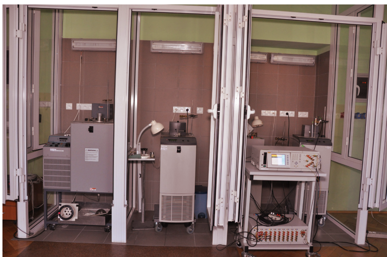
Stanowisko pomiarowe wzorca roboczego jednostki temperatury realizujące metodę porównawczą w zakresie (-80 ÷ 550) °C
