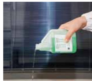
Kalibrierbehälter leeren Empty calibration compartment
