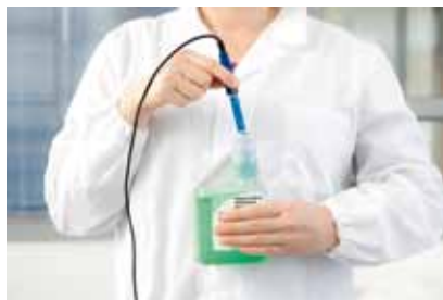
Elektrode kalibrieren Calibrate electrode
